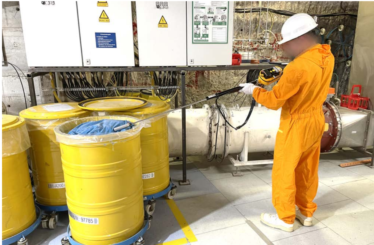
Messung der Ortsdosisleistung an Betriebsabfällen
